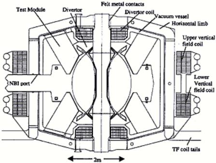
Figure 28. The MAST Tokamak.
